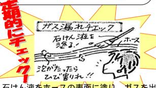
石けん液<del>をホースの表面に塗り、ガスを</del>出 してみて、泡がたってきたらひび割れてい る証拠!ゴムホ<mark>→ス</mark>の交換<mark>は</mark>2 年に 1 回を めどに!
